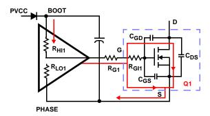
FIGURE 3. TYPICAL UPPER-GATE DRIVE TURN-ON PATH
