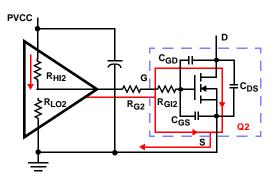
FIGURE 4. TYPICAL LOWER-GATE DRIVE TURN-ON PATH
