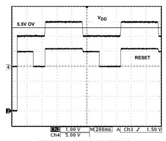
FIGURE 14. 5V OV/UV MONITORING
