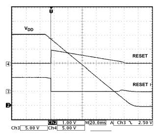
FIGURE 12. RESET AND RESET DEASSERTION
