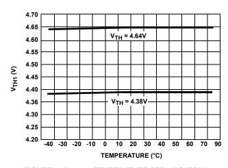
FIGURE 7.  $V_{TH1}$  vs TEMPERATURE FOR 5V SUPPLY
