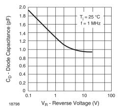
Fig. 1 - Diode Capacitance
