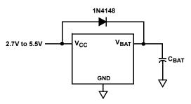
FIGURE 20. SUPERCAPACITOR CHARGING CIRCUIT
