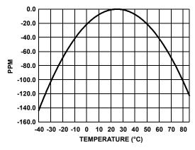
FIGURE 17. RTC CRYSTAL TEMPERATURE DRIFT
