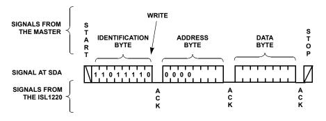
FIGURE 14. BYTE WRITE SEQUENCE
