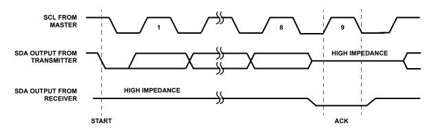
FIGURE 13. ACKNOWLEDGE RESPONSE FROM RECEIVER
