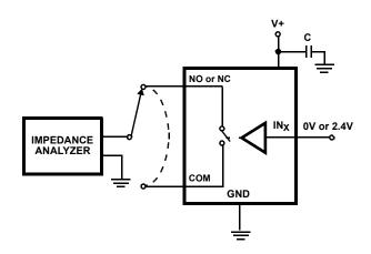
FIGURE 7. CAPACITANCE TEST CIRCUIT
