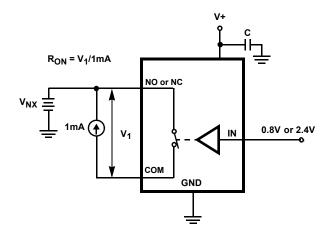
FIGURE 5. RON TEST CIRCUIT
