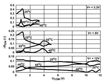
FIGURE 11. R<sub>ON</sub> MATCH vs SWITCH VOLTAGE
