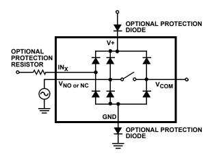
FIGURE 8. OVERVOLTAGE PROTECTION
