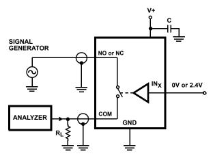
FIGURE 4. OFF ISOLATION TEST CIRCUIT
