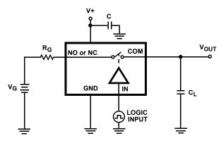
FIGURE 2B. TEST CIRCUIT
