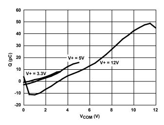
FIGURE 12. CHARGE INJECTION vs SWITCH VOLTAGE
