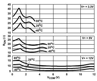
FIGURE 10. ON RESISTANCE vs SWITCH VOLTAGE
