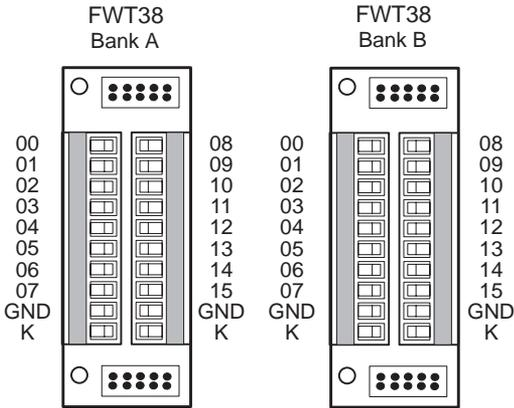
**Figure C-3. FWT38 Pinouts**
