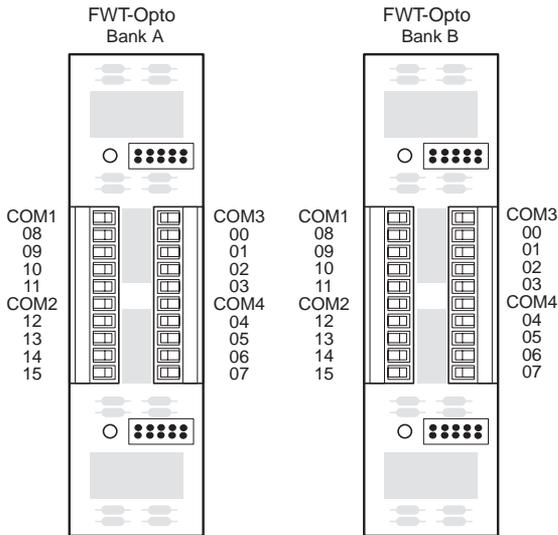
**Figure C-7. FWT-Opto Pinouts**
